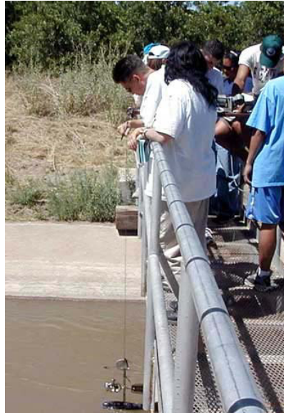
ภาพที่ 9.3 แสดงการวัดอัตราการไหลของน้ำในคลองส่งน้ำด้วยเครื่องวัดอัตราการไหลของน้ำ
